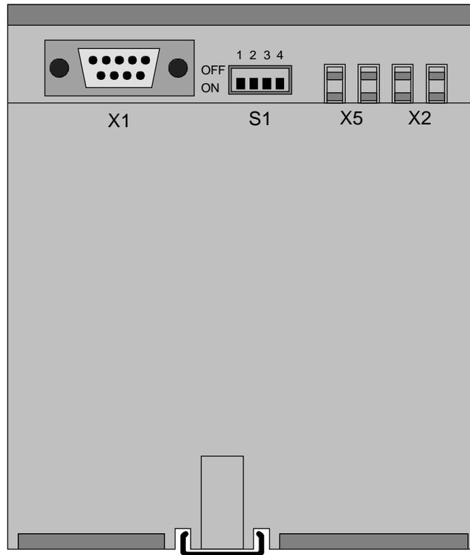
Bild 5: Ansicht des Schalters S1 in Lieferstellung
