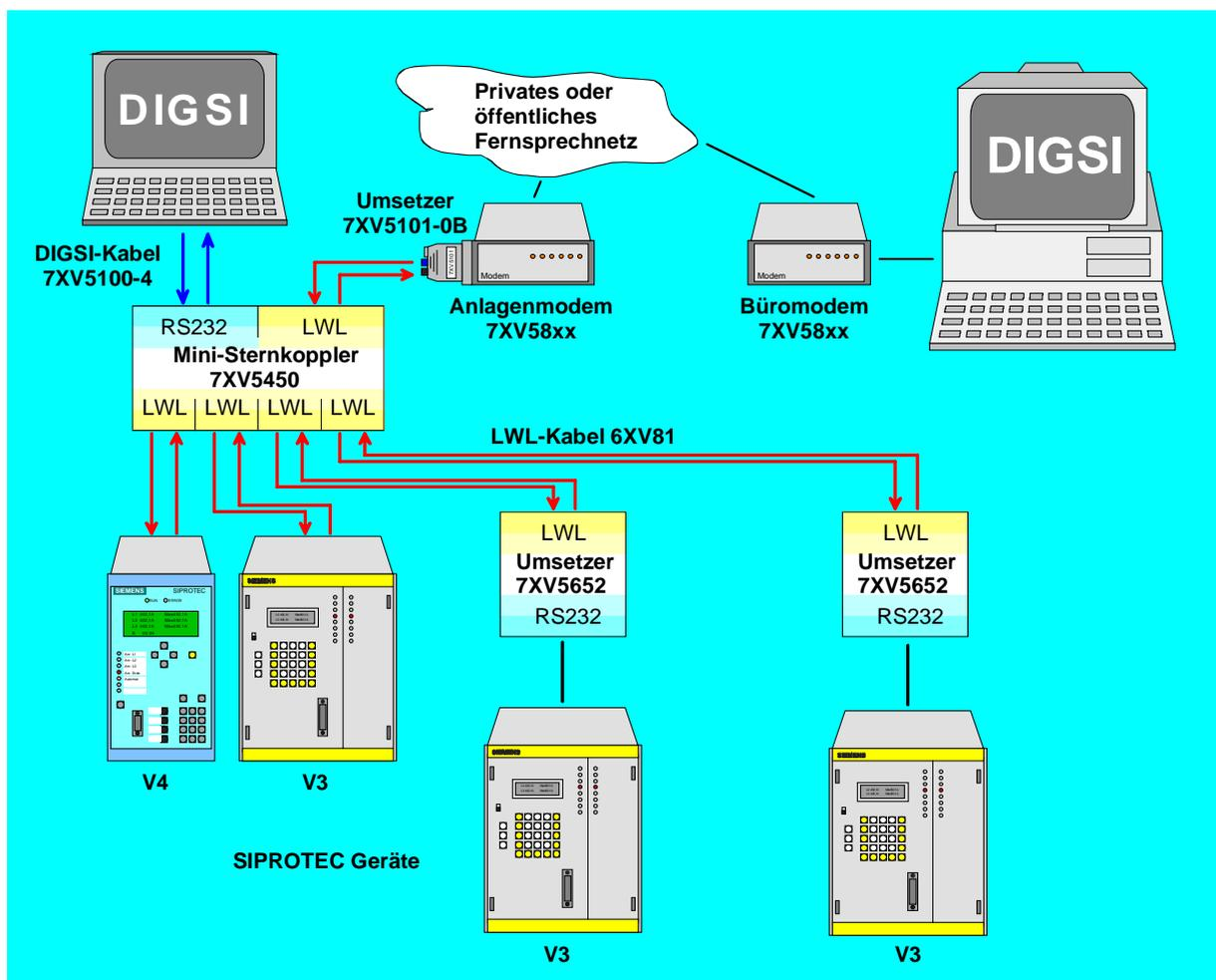
Bild 6: Optische Sternstruktur für Geräte V3 mit RS232-Schnittstelle
