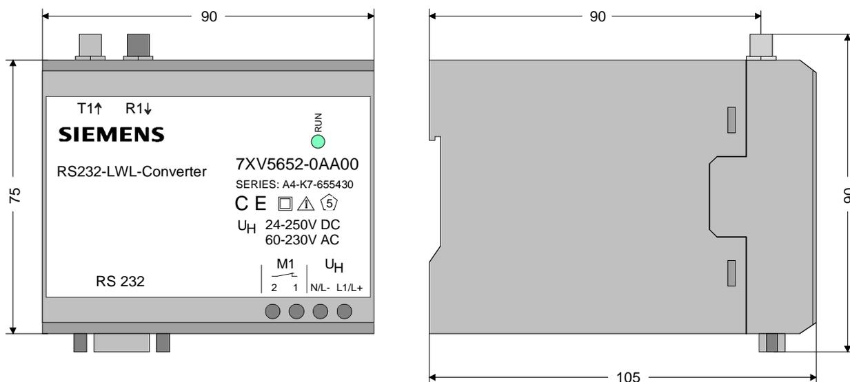
Bild 3: Abmessungen
