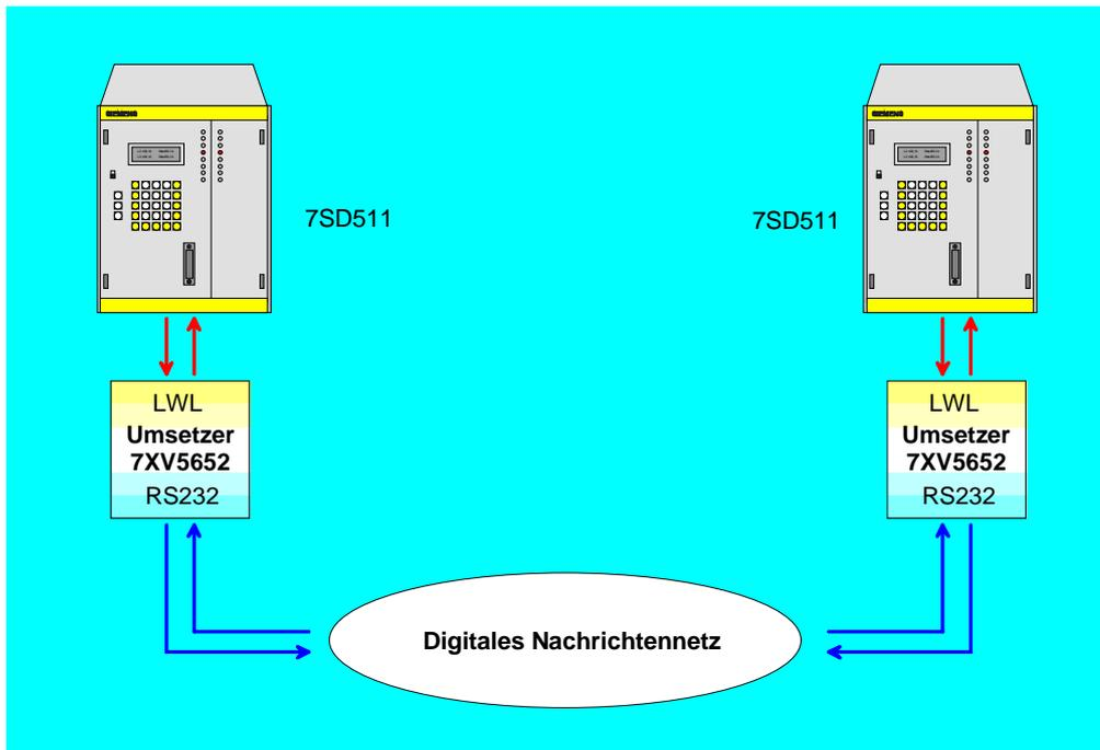
Bild 7: Datenübertragung bei Differentialschutzgeräten mit LWL-Schnittstelle
