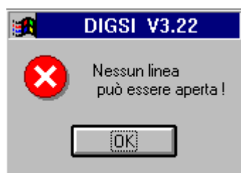
Figura 4.63 Messaggio dovuto ad un indirizzo dell'apparecchio già esistente
