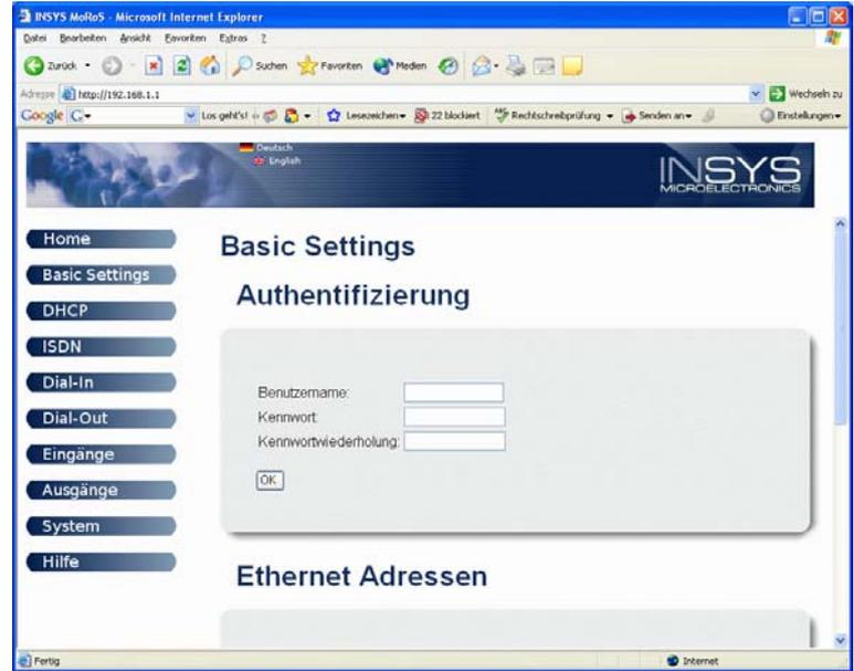
Unter „**Ethernet Adressen**“ kann die IP-Adresse und Subnetmaske des ISDN-Routers geändert, d.h. dem Subnet in der Anlage (z.B. **192.168.20.1**) angepasst werden.
