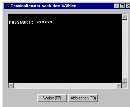
Das Anlagenmodem ist nun transparent geschaltet und die Kommunikation zum Schutzgerät wird aufgebaut.
