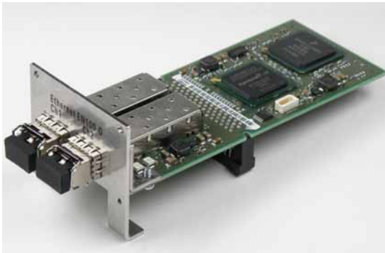
Mit dem zweiten fährt man besser: Die optischen Schnittstellen des EN100 sind doppelt ausgeführt
