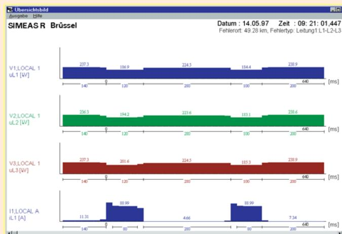
Bild 10 Effektivwertdarstellung eines dreipoligen Fehlers
