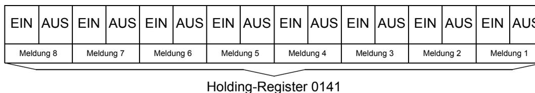
Mit diesem Datenformat können bis zu acht Befehle über das Holding-Register übertragen werden, bei denen die EIN/AUS-Bits entweder auf 0/1 oder auf 1/0 gesetzt sind. Sind diese Bits auf 0/0 oder 1/1 gesetzt, erfolgt keine Auswertung.
