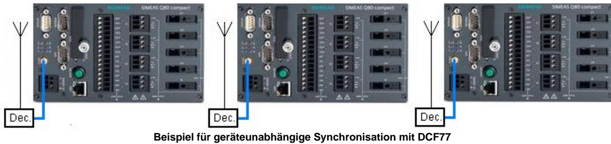
Beispiel für geräteunabhängige Synchronisation mit DCF77
