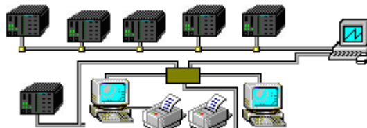
Beispiel für ein komplexes Netzwerk mit PCs und mehreren SIMEAS Q80 7KG8080
