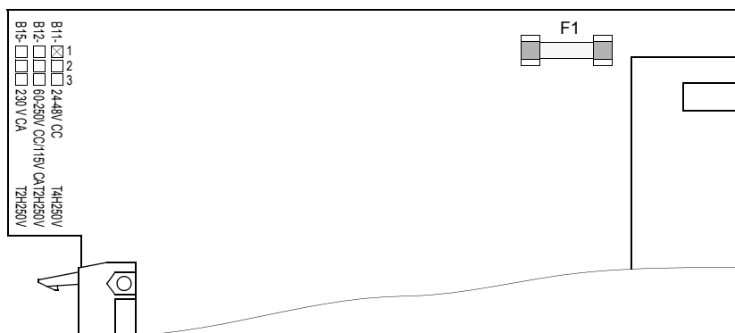
Figura 8-12 Minifusible de la fuente de alimentación situada en el módulo del procesador CPU
