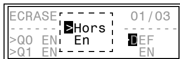
Figure 6-57 Fenêtre de sélection pour le reroutage d'une position de l'organe de manœuvre à l'écran
