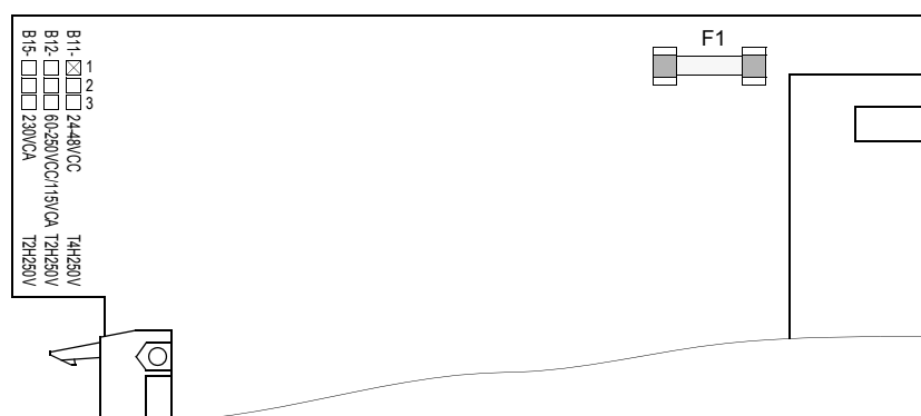
Figure 8-12 Fusible pour faible intensité de l'alimentation électrique de la carte processeur UC
