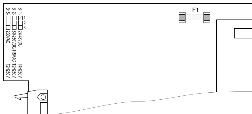
Fig. 8-12 Fusibile per correnti deboli dell'alimentazione elettrica del modulo del processore CPU
