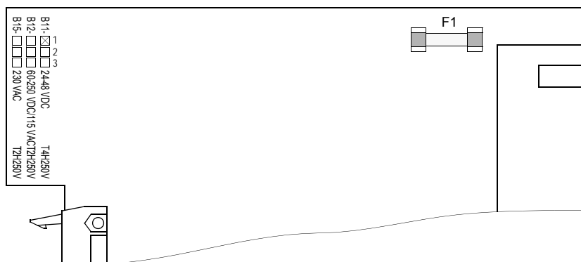
Рис. 8-11 Миниатюрный предохранитель источника питания платы центрального процессора CPU
