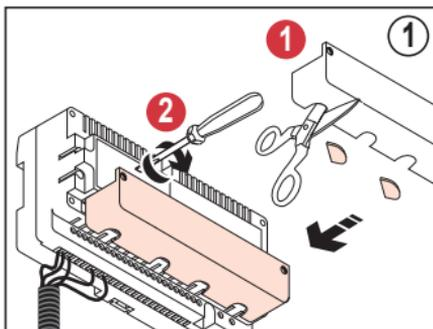
• Вырезать в крышке отверстия для проводников и закрыть ею клеммы подключения питания.
