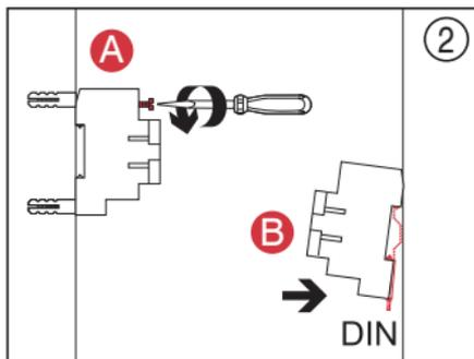
• Настенный монтаж или крепление на DIN-рейку.
