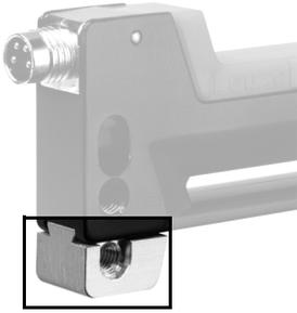
BT-GS6X oder BT-GS6X.L werden benötigt, wenn Befestigungskompatibilität zur Gabellichtschranke GS 06 gewünscht wird. Bei Verwendung ist auf festen Sitz zu achten (Madenschraube anziehen).
