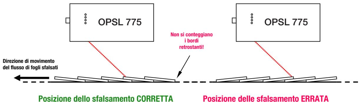
Figura 4: OP SL 775 - Flusso di fogli sfalsati ed orientamento dello sfalsamento
