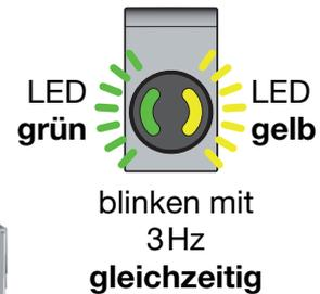
**Teach für erhöhte Sensor-Empfindlichkeit (hochtransparente Flaschen und Folien < 20µm Dicke)**
