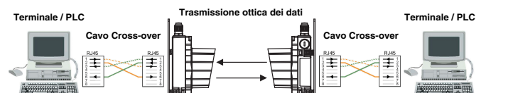
Figura 4.7: DDLS 200 tra terminale/PLC e terminale/PLC
