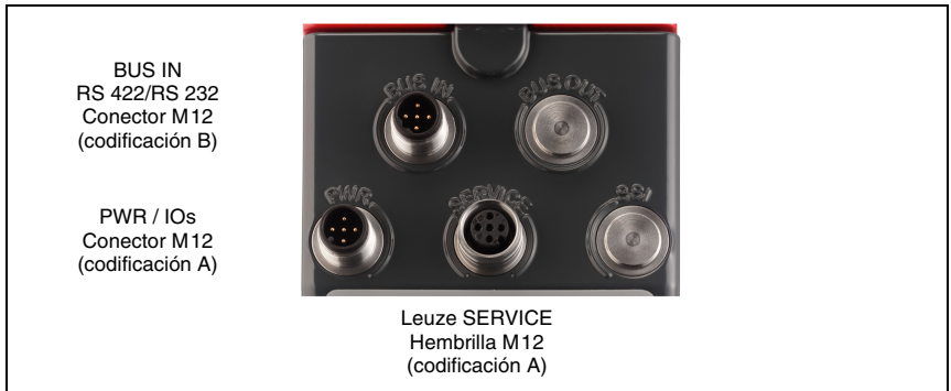
Figura 7.1: Conexiones del AMS 300 i
