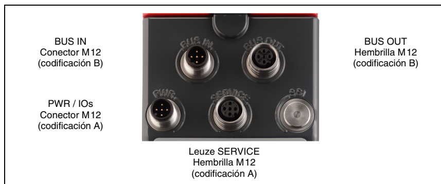
Figura 7.1: Conexiones del AMS 301 i
