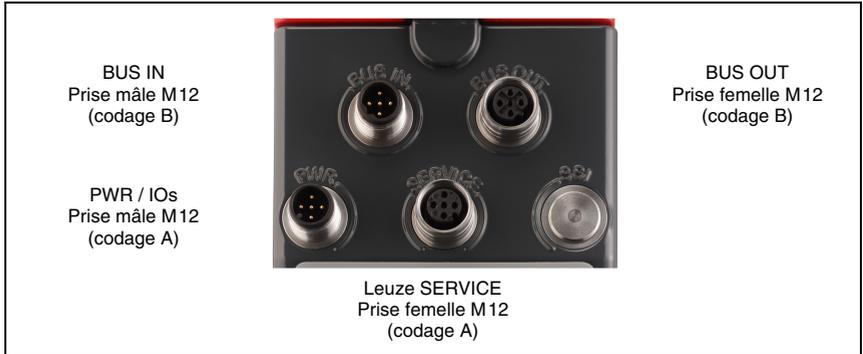
Figure 7.1 : Raccordements de l'AMS 301*i*
