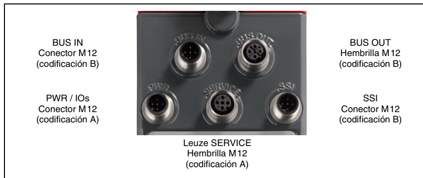
Figura 7.1: Conexiones del AMS 304 i
