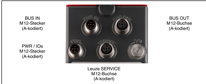
Bild 7.1: Anschlüsse des AMS 335 i
