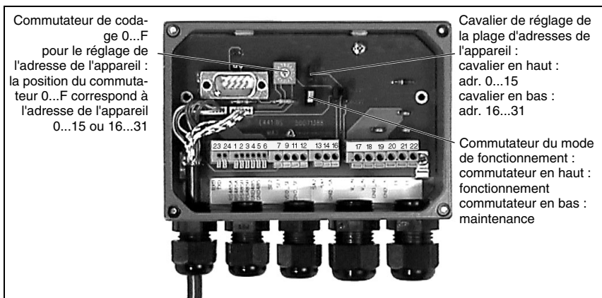
Figure 7.1 : Éléments de réglage de la MA 2
