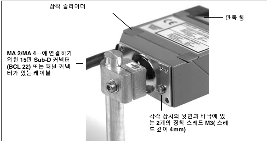
그림 3.1: BCL 21/22 장치 조립
