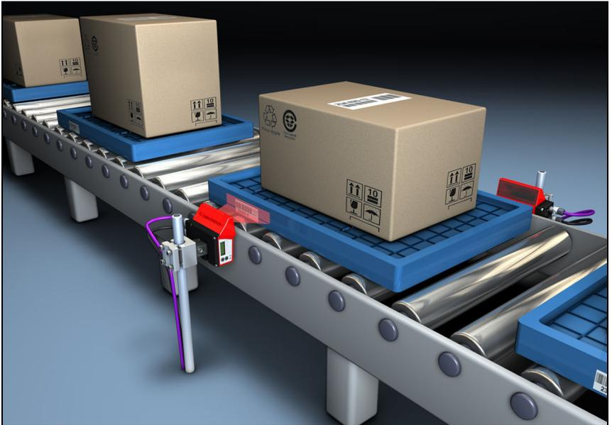
Figure 4.12 : Principe de déviation du scanner multitrace
