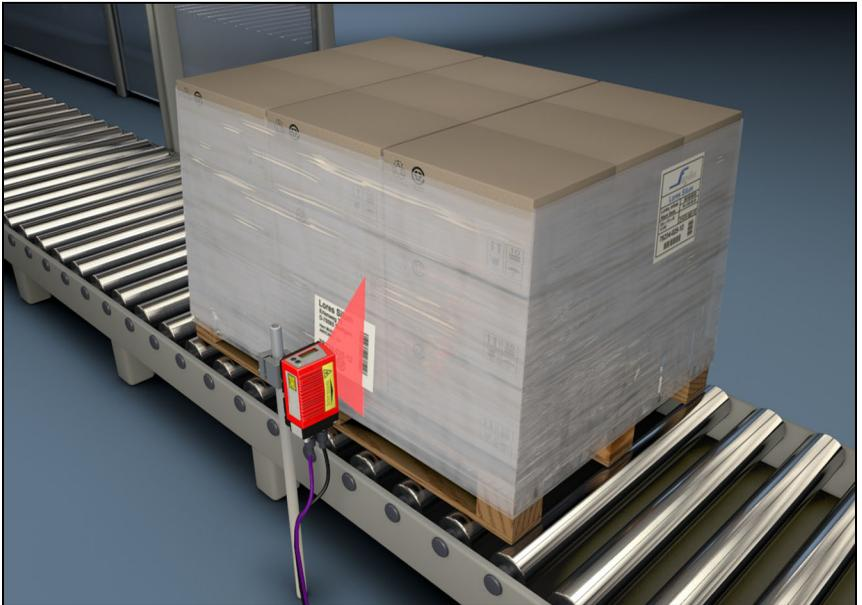
Figura 4.10: Principio di deflessione per lo scanner a linee
