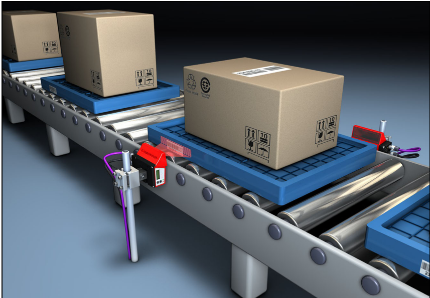
Figura 4.10: Principio de barrido del escáner de retícula
