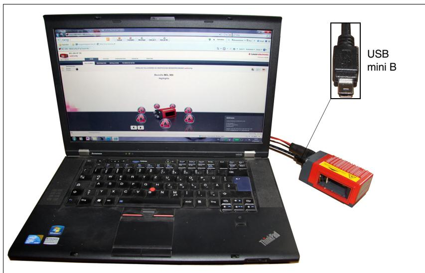
Figure 9.1 : Raccordement au port USB de MAINTENANCE
