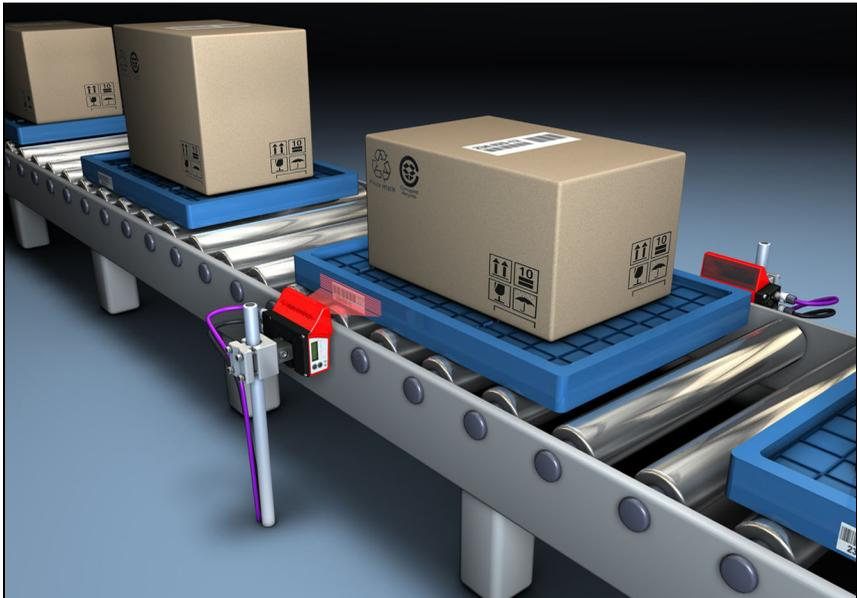
Figure 4.10 : Principe de déviation du scanner multitrace
