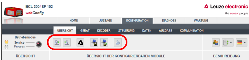
Bild 10.1: Speicherung von Konfigurationsdaten im webConfig Tool
