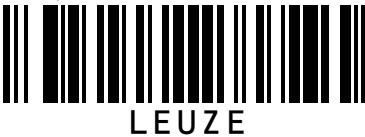
Bild 15.4: Barcode Muster-Etiketten (Modul 0,5)
