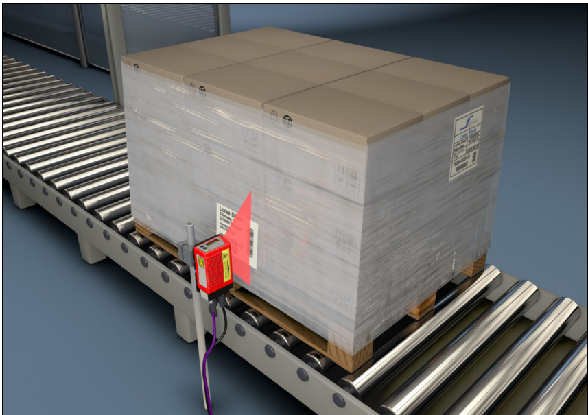
Figura 4.8: Principio de barrido del escáner lineal
