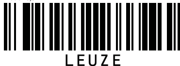
Figure 15.4 : Étiquettes-modèles de codes à barres (module 0,5)
