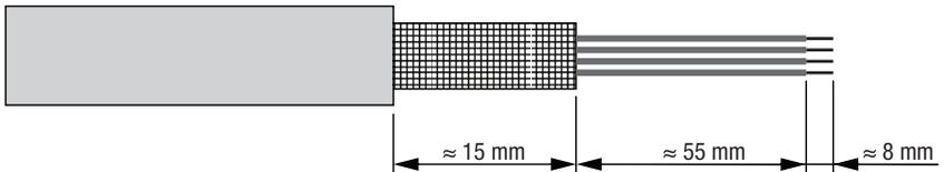
Bild 7.4: Leitungskonfektionierung für Klemmenhaube MK 348
