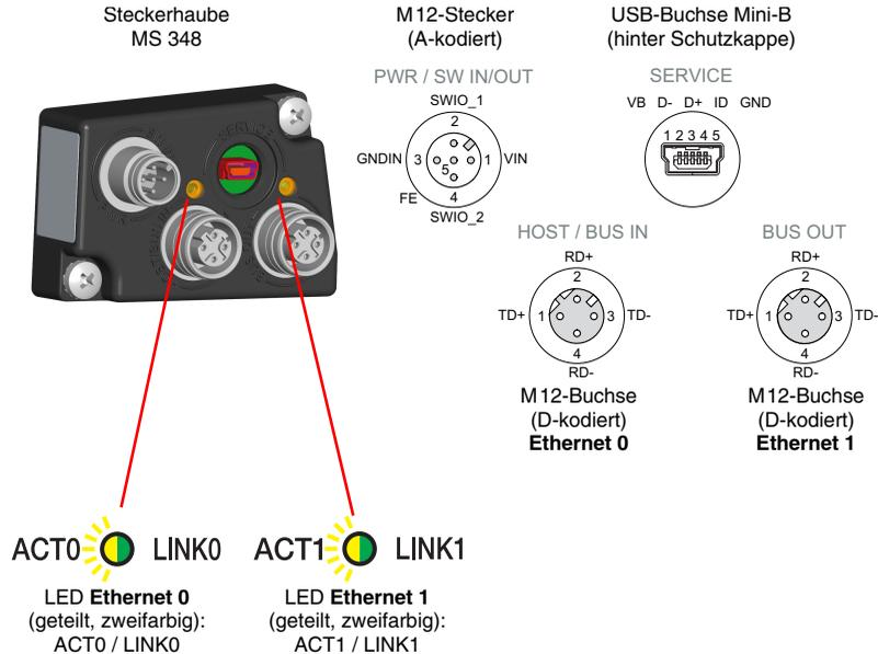
Bild 3.1: BCL 348*i* - Steckerhaube MS 348 mit M12-Steckverbindern
