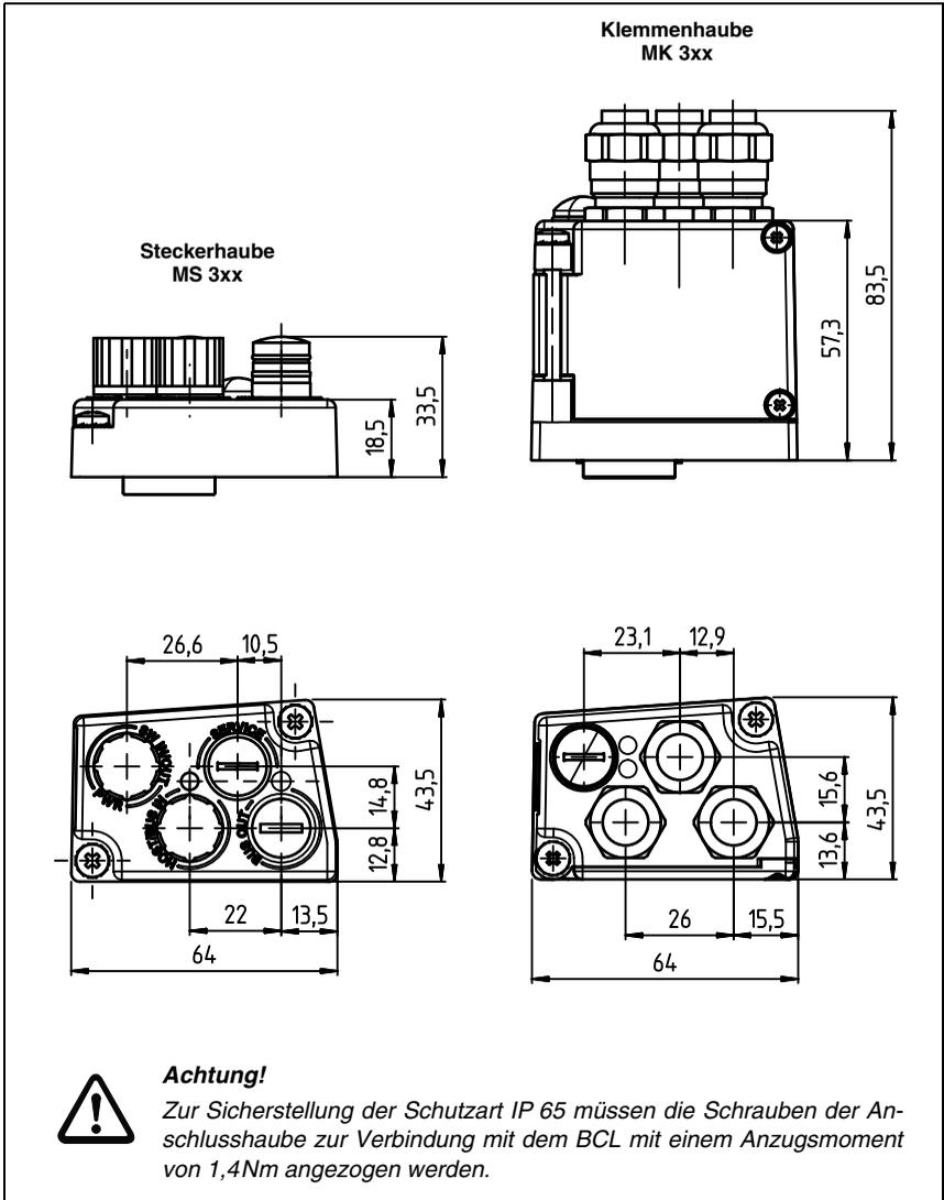
Bild 5.5: Maßzeichnung Steckerhaube MS 3xx / Klemmenhaube MK 3xx
