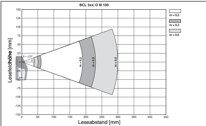
Bild 5.15: Seitliche Lesefeldkurve "Medium Density" für Schwenkspiegelscanner
