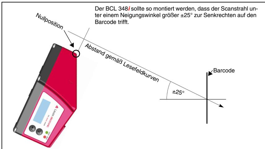
Bild 6.8: Totalreflexion – BCL 348*i* mit Schwenkspiegel
