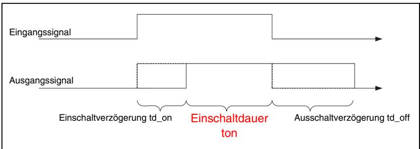
Bild 10.10: Einschaltdauer im Modus Eingang
