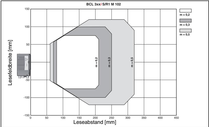
Bild 5.12: Lesefeldkurve "Medium Density" für Linienscanner ohne Umlenkspiegel
