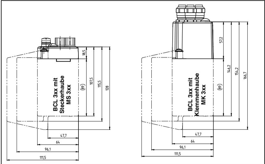
Bild 5.1: Maßzeichnung Komplettansicht BCL 348*i* mit MS 3xx / MK 3xx
