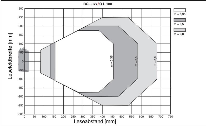
Bild 5.22: Lesefeldkurve "Ultra Low Density" für Schwenkspiegelscanner
