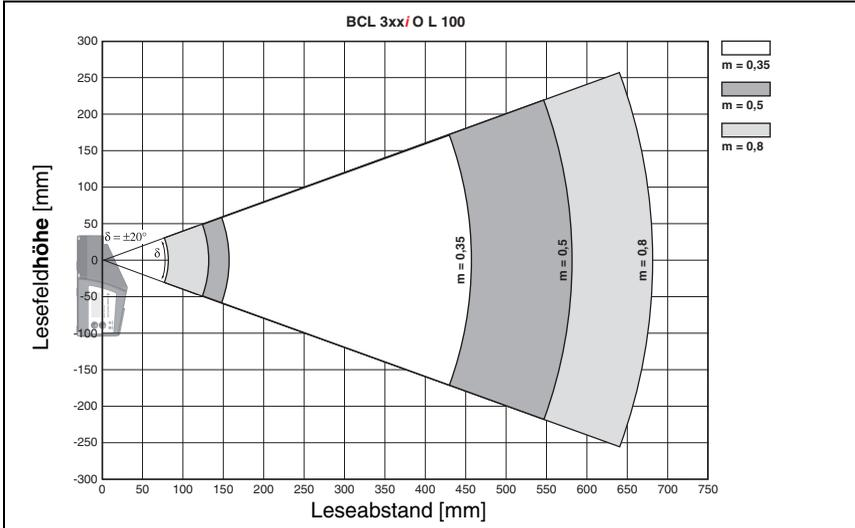
Bild 5.23: Seitliche Lesefeldkurve "Ultra Low Density" für Schwenkspiegelscanner
