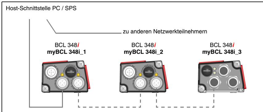
Bild 4.12: PROFINET-IO in Linien-Topologie
