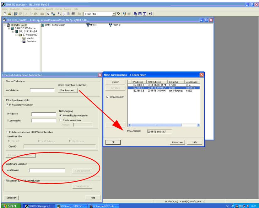
Bild 3.5: Zuweisen der Gerätenamen an die projizierten IO-Devices
