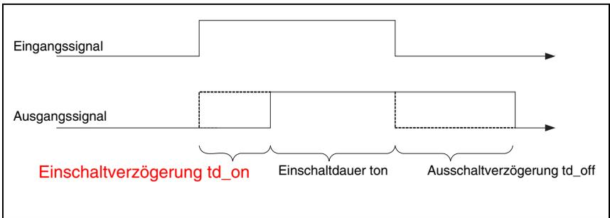
Bild 10.9: Einschaltverzögerung im Modus Eingang
