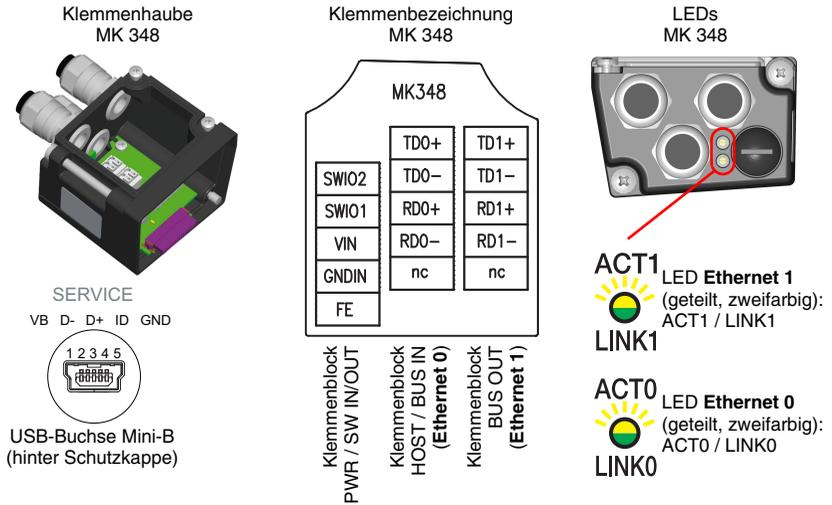
Bild 3.2: BCL 348*i* - Klemmenhaube MK 348 mit Federkraftklemmen
