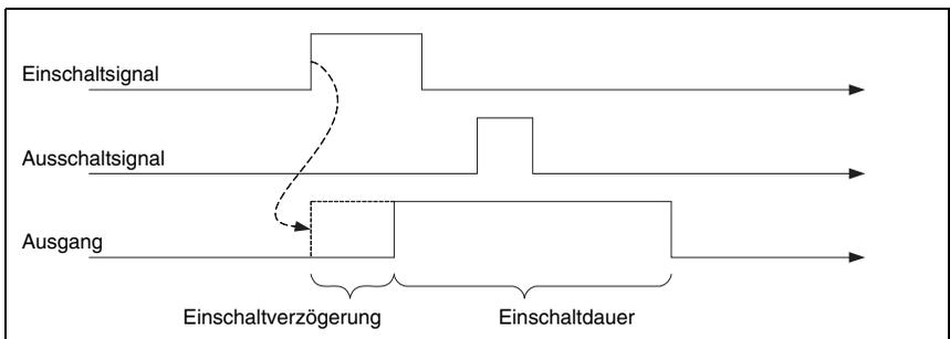
Bild 10.7: Beispiel 2 Einschaltverzögerung > 0 und Einschaltdauer > 0
