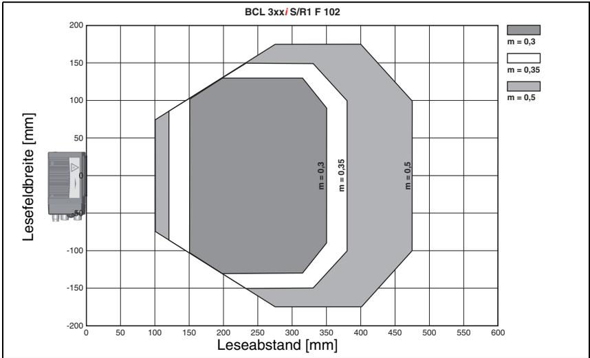
Bild 5.16: Lesefeldkurve "Low Density" für Linienscanner ohne Umlenkspiegel
