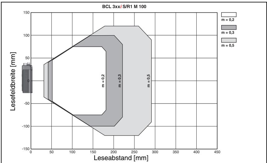
Bild 5.13: Lesefeldkurve "Medium Density" für Linienscanner mit Umlenkspiegel
