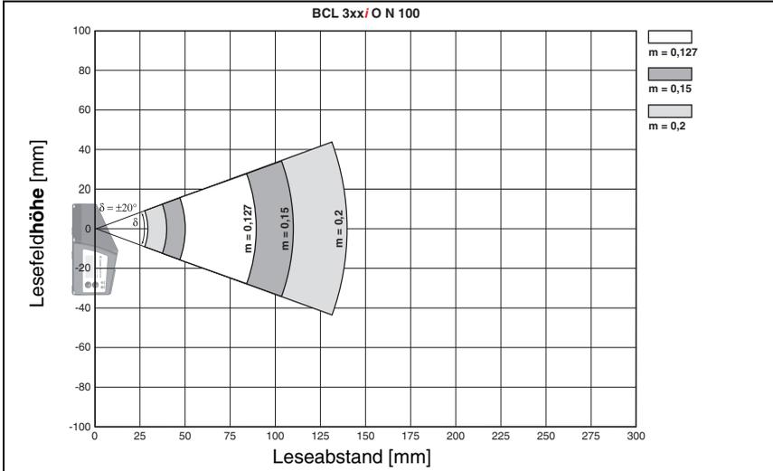
Bild 5.11: Seitliche Lesefeldkurve "High Density" für Schwenkspiegelscanner
