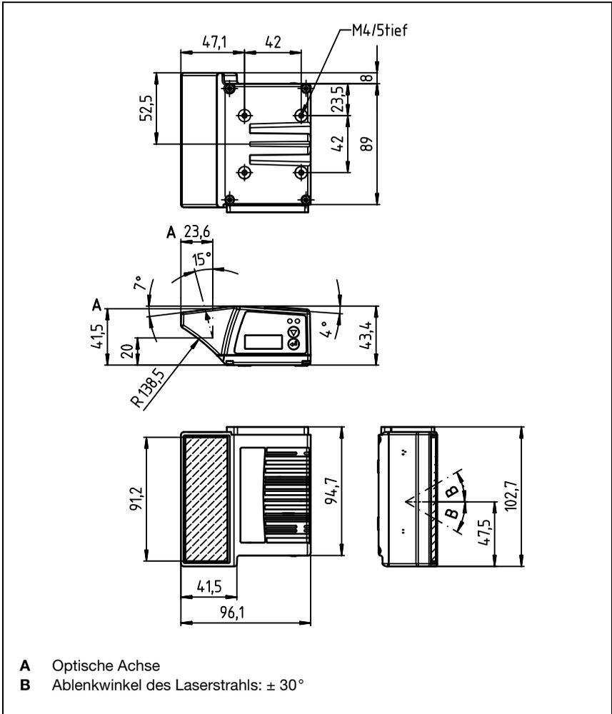
Bild 5.3: Maßzeichnung Scanner mit Umlenkspiegel BCL 348/ S...100
