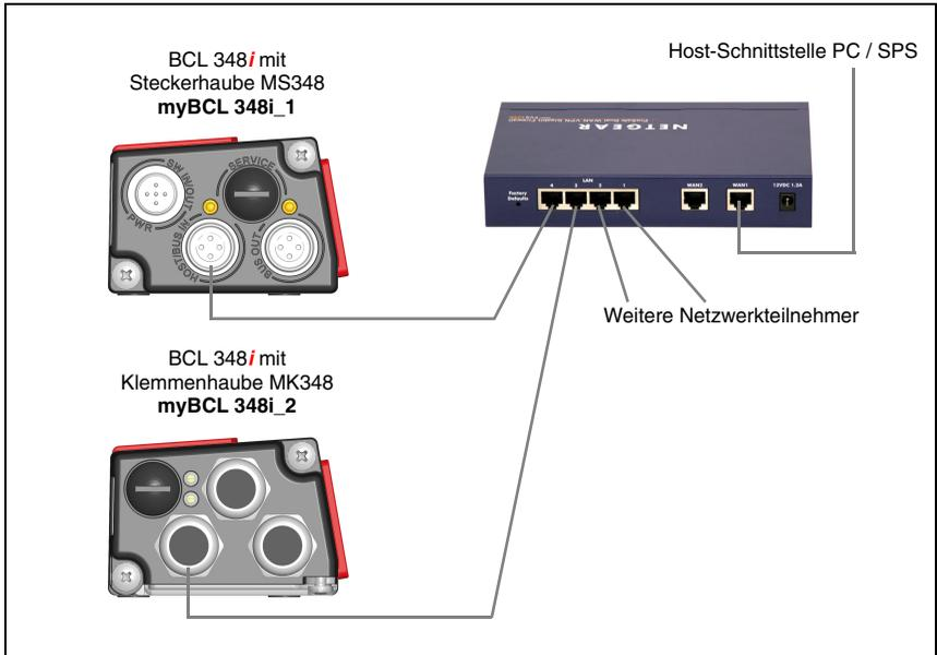
Bild 4.11: PROFINET-IO in Stern-Topologie
