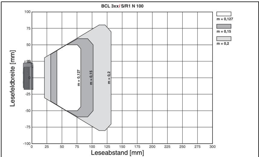
Bild 5.9: Lesefeldkurve "High Density" für Linienscanner mit Umlenkspiegel
