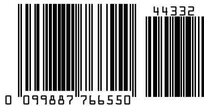
Bild 15.4: Barcode Muster-Etiketten (Modul 0,5)
