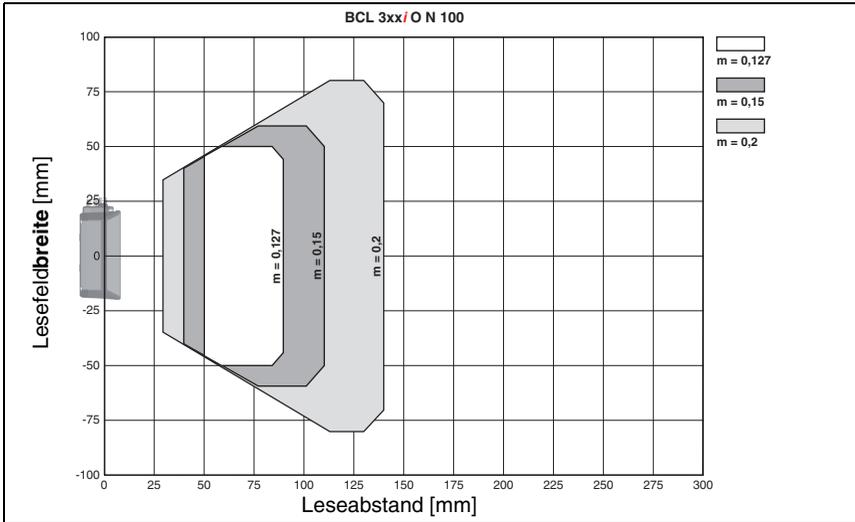
Bild 5.10: Lesefeldkurve "High Density" für Schwenkspiegelscanner
