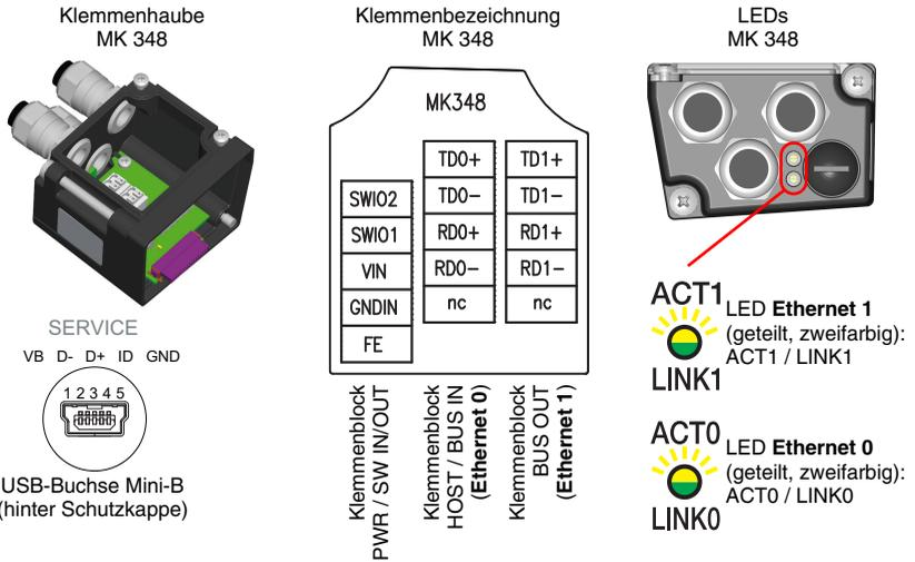
Bild 10.2: BCL 348*i* - Klemmenhaube MK 348 mit Federkraftklemmen
