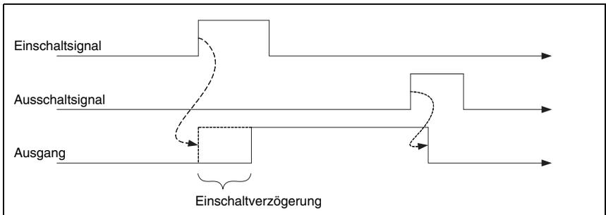
Bild 10.6: Beispiel 1 Einschaltverzögerung > 0 und Einschaltdauer = 0
