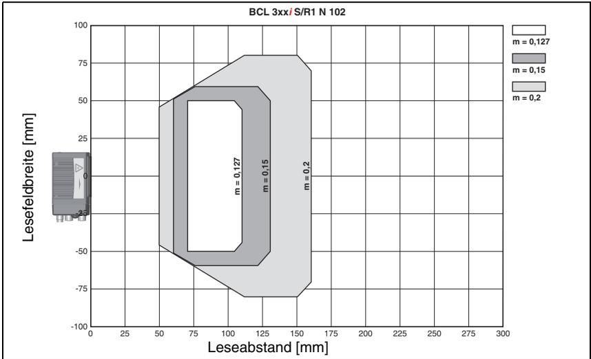
Bild 5.8: Lesefeldkurve "High Density" für Linienscanner ohne Umlenkspiegel
