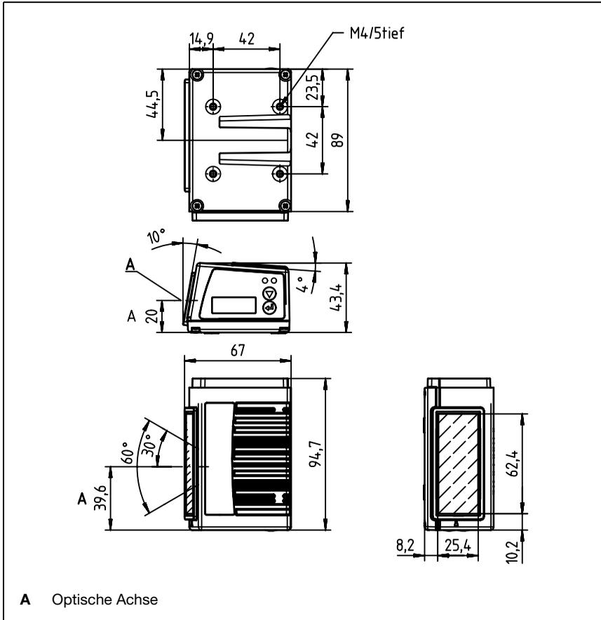
Bild 5.2: Maßzeichnung Linienscanner BCL 348*i*S...102
