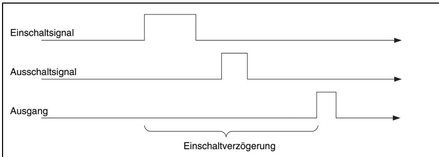
Bild 10.8: Beispiel 3 Einschaltverzögerung  $> 0$  Ausschaltsignal vor Ablauf der Einschaltverzögerung
