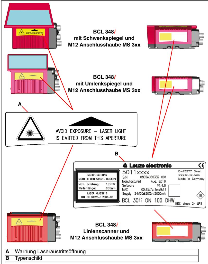
Bild 2.1: Anbringung der Aufkleber mit Warnhinweisen am BCL 348*i*
