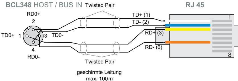
Bild 7.3: Kabelbelegung HOST / BUS IN auf RJ-45
