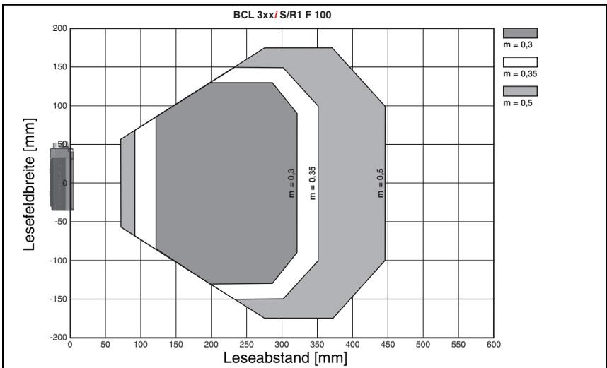
Bild 5.17: Lesefeldkurve "Low Density" für Linienscanner mit Umlenkspiegel
