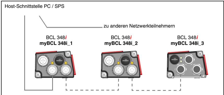
Bild 7.5: PROFINET-IO in Linien-Topologie
