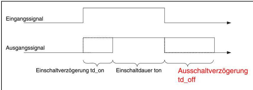
Bild 10.11: Ausschaltverzögerung im Modus Eingang
