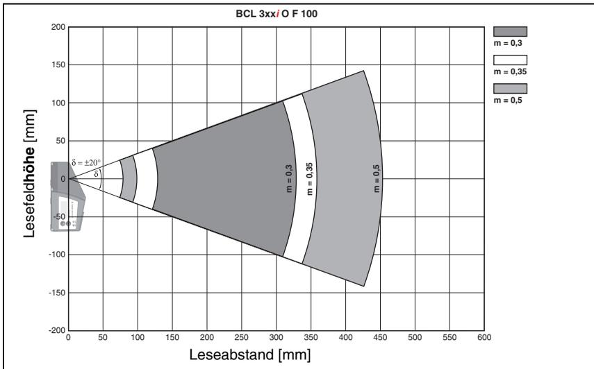
Bild 5.19: Seitliche Lesefeldkurve "Low Density" für Schwenkspiegelscanner
