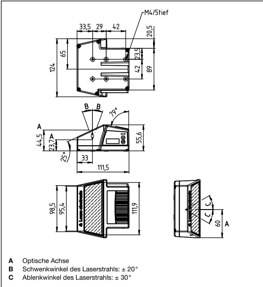
Bild 5.4: Maßzeichnung Scanner mit Schwenkspiegel BCL 348i/O...100
