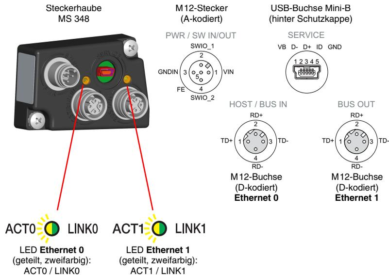
Bild 10.1: BCL 348*i* - Steckerhaube MS 348 mit M12-Steckverbindern
