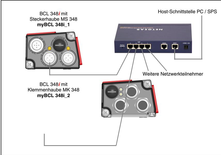
Bild 7.4: PROFINET-IO in Stern-Topologie
