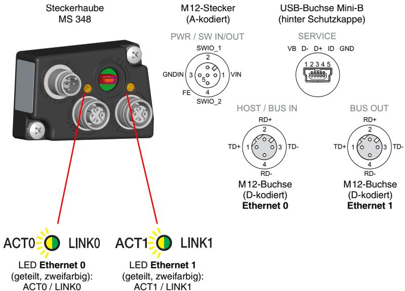
Bild 7.2: BCL 348*i* - Steckerhaube MS 348 mit M12-Steckverbindern
