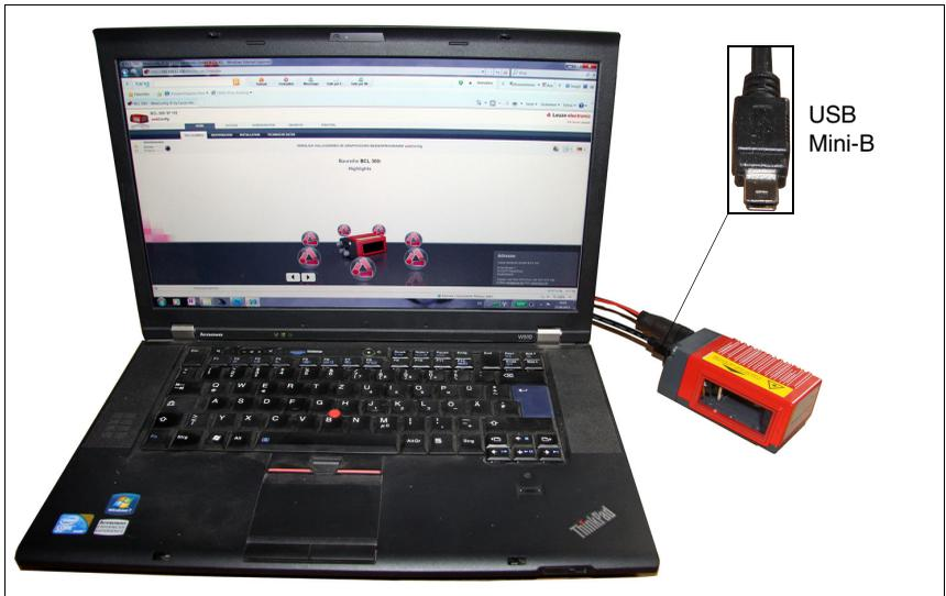
Figura 9.1: Conexión de la interfaz de servicio USB
