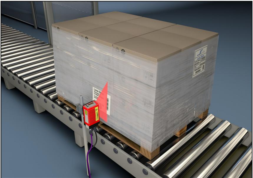
Figura 4.8: Principio de barrido del escáner lineal
