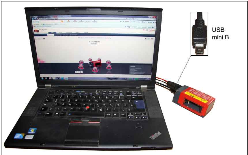
Figure 9.1 : Raccordement au port USB de MAINTENANCE
