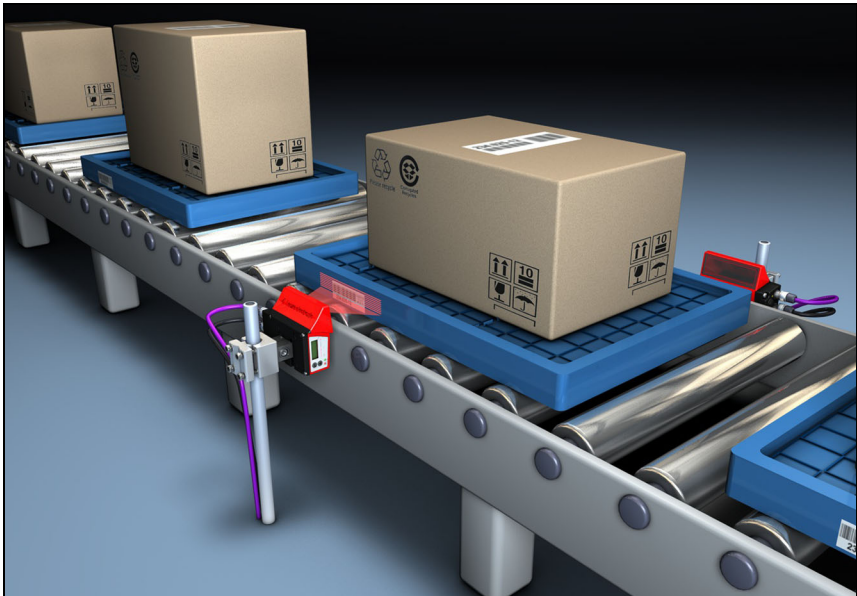
Figure 4.10 : Principe de déviation du scanner multitrace
