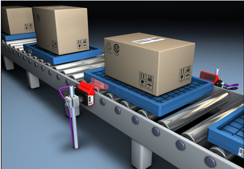
Figura 4.10: Principio de barrido del escáner de retícula
