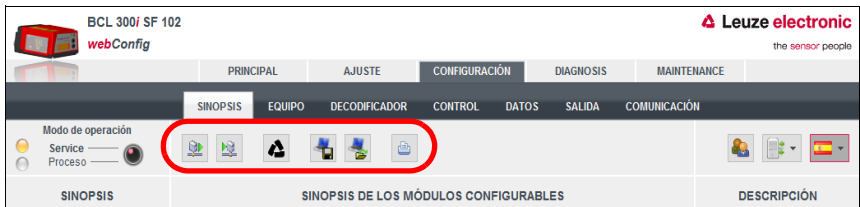
Figura 10.17: Almacenamiento de los datos de configuración en la herramienta webConfig
