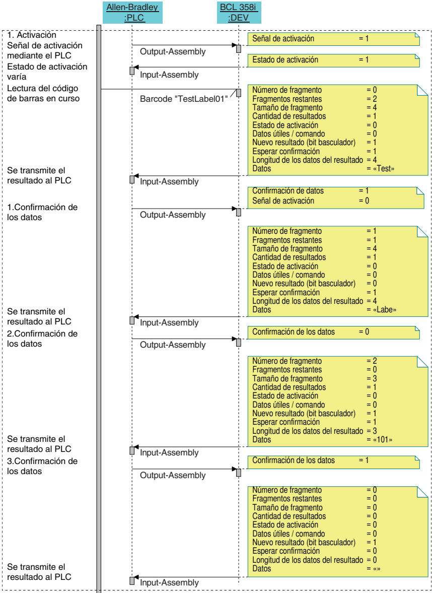
Figura 10.13: Diagrama secuencial del intercambio de datos - ejemplo 3
