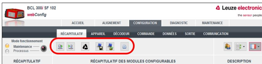
Figure 10.17 : Sauvegarde des données de configuration avec l'outil webConfig
