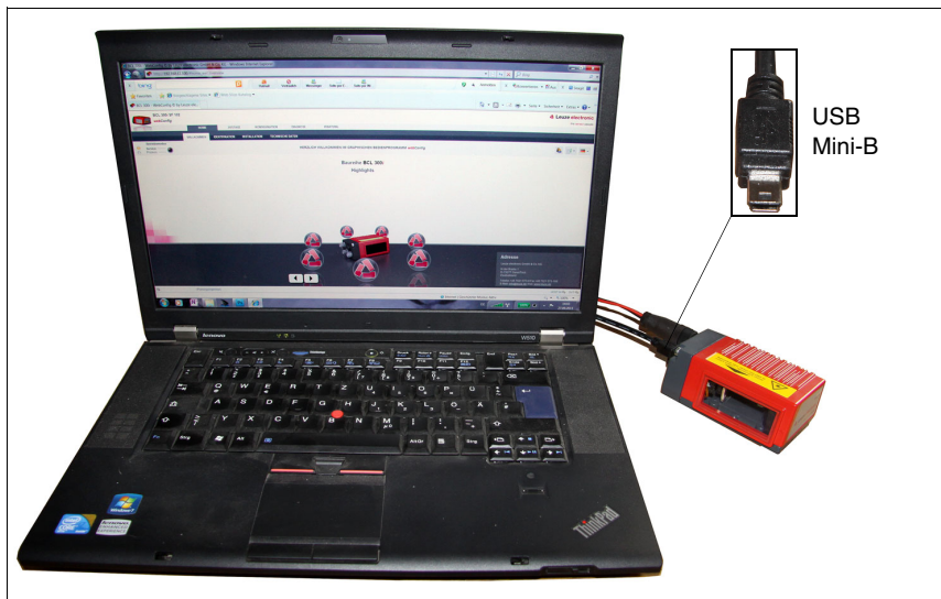
Figura 9.1: Collegamento della porta USB di manutenzione
