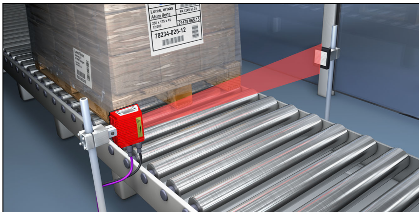
Figura 4.11: Disposizione del riflettore per autoRefIAct
