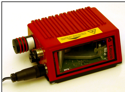
Figura 10.5: BCL 500 i \ BCL 501 i con memoria dei parametri montata
