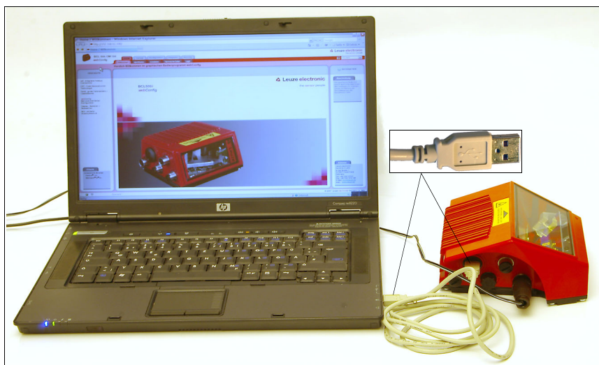
Bild 9.1: Anschluss der SERVICE USB-Schnittstelle
