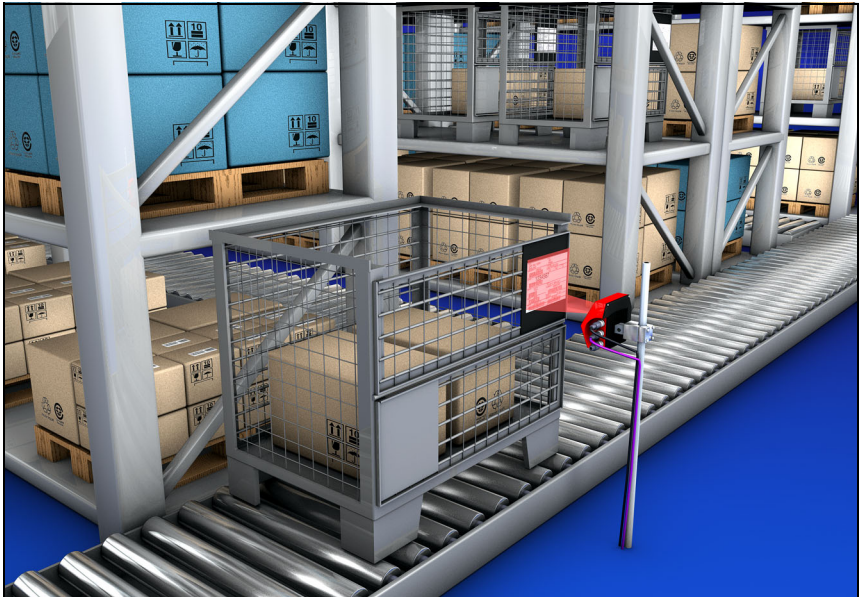
Figura 4.5: Principio de barrido del escáner lineal con suplemento de espejo orientable
