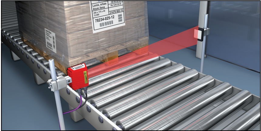
圖 4.9： autoReflAct 的反射器佈置
