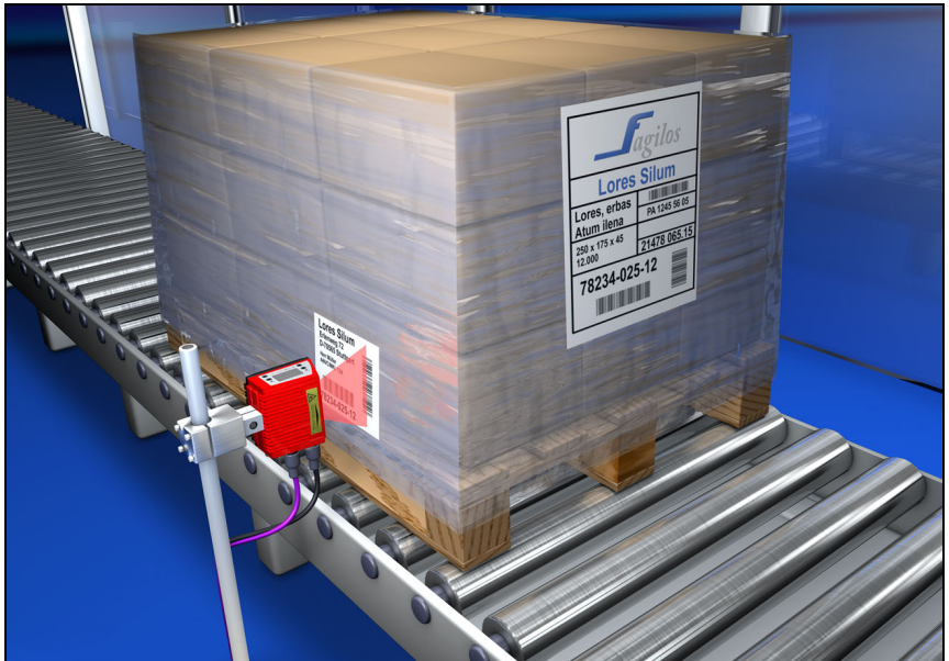
Bild 4.4: Ablenkprinzip für den Linienscanner
