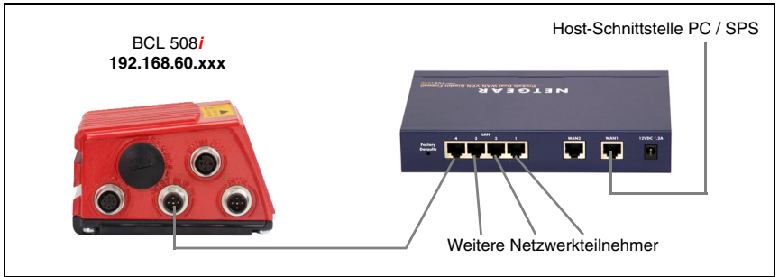
Bild 7.6: Ethernet in Stern-Topologie
