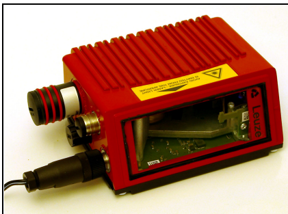
Bild 10.4: BCL 508 i mit montiertem Parameterspeicher
