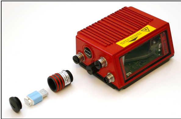
Bild 10.3: Montage des externen Parameterspeichers
