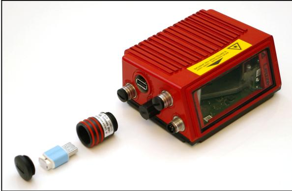
Figura 10.3: Montaje de la memoria de parámetros externa
