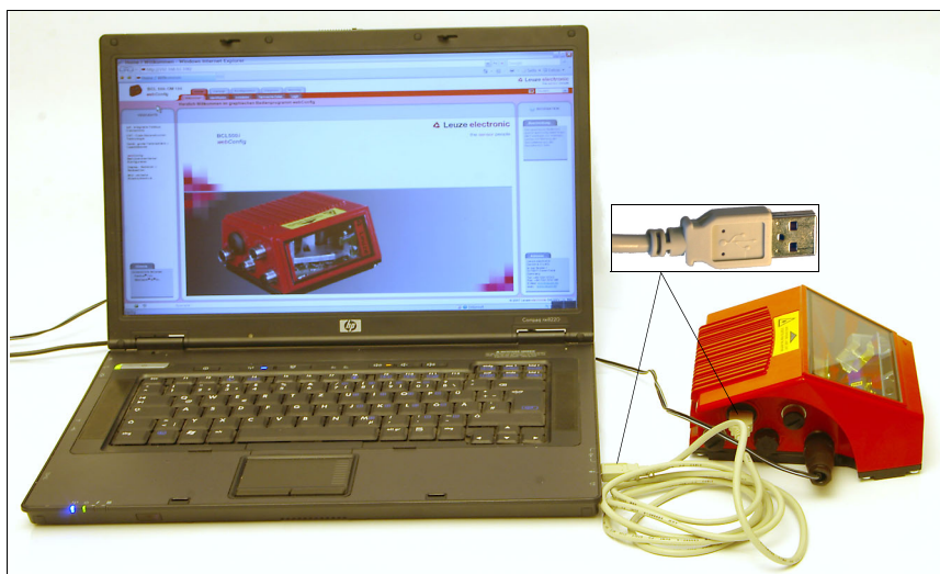
Figure 9.1 : Raccordement au port USB de MAINTENANCE
