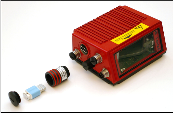
Figure 10.3 : Montage de la mémoire de paramètres externe
