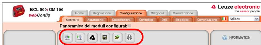
Figura 10.2: Salvataggio dei dati di configurazione nel webConfig Tool
