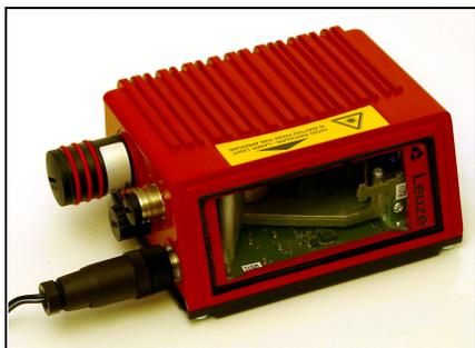
Figura 10.4: BCL 508*i* con memoria dei parametri montata
