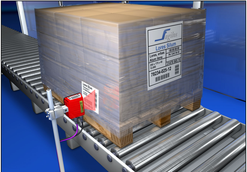
Bild 4.4: Ablenkprinzip für den Linienscanner
