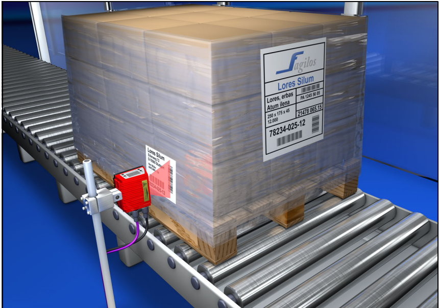
Figura 4.4: Principio de barrido del escáner lineal
