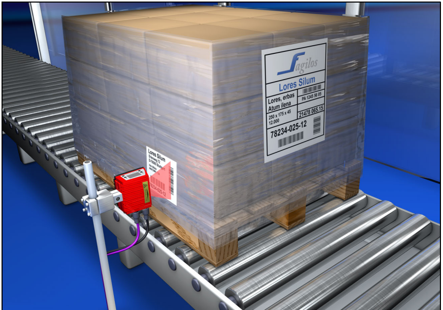
Figure 4.4 : Principe de déviation du scanner monotrame
