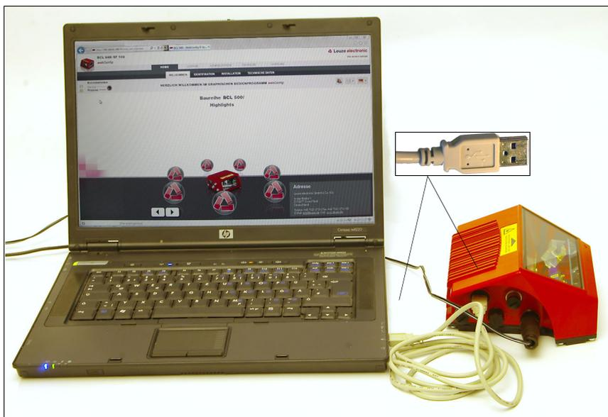
Figura 9.1: Collegamento della porta USB di manutenzione
